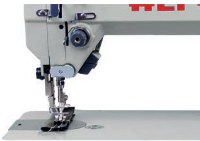
Sistema de doble arrastre: prensatelas y dientes
