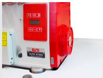
Marcaje de regulador de puntada
