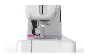
Tire hacia abajo del mecanismo DFS y gírelo hacia atrás para desengancharlo.
