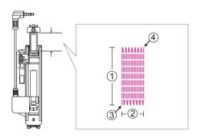
El tamaño de un ciclo de zurcido es variable. Sin embargo, la máxima longitud de puntada es de 2,6cm, y el máximo ancho de puntada es de 7mm.
