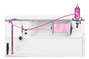
Coloque el segundo portacarrete en el orificio de la parte superior de la máquina y coloque el fieltro del portacarrete y el hilo en el segundo portacarrete.
