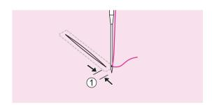
Coloque la tela de manera que la aguja quede 2mm por delante de la zona a zurcir y luego baje la palanca del prénsatelas.
