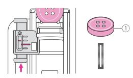
El largo del ojal puede que necesite incrementar para un boton grueso, ajuste el apuntador hacia "+" para mejor ajuste.
