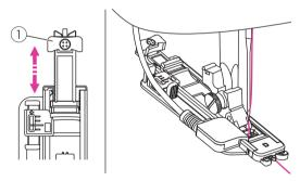
Extienda la placa de soporte del boton y ajuste la longitud deseada. Ajuste el ancho de puntada y largo de puntada deseada a su ancho y densidad.
