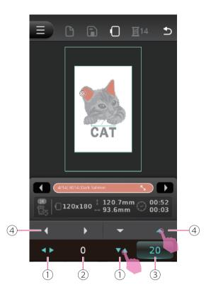
Haga clic en el icono Dirección para mostrar la lista multifunción. El valor predeterminado es 0, El icono de flecha izquierda y derecha o arriba y abajo en la lista multifunción puede ajustar la posición del eje X y del eje Y.
