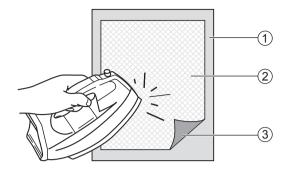
Si está utilizando estabilizadores adhesivos, coloque la superficie adhesiva del material estabilizador frente al revés de la tela, y planche.
