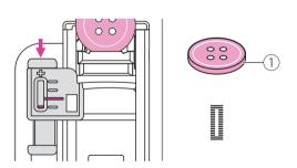
El largo del ojal puede que necesite disminuir para un boton delgado, ajuste el apuntador hacia "-" para mejor ajuste.
