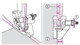
Coloque la tela debajo del prensatelas. Gire el volante hacia adelante hasta que la aguja se balancee completamente hacia la izquierda. Sólo debe perforar el pliegue de la tela. Si no es así, ajuste el ancho de la puntada. Ajuste la guía girando la perilla para que la guía sólo descanse contra el pliegue.
