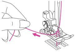
Tire del hilo superior suavemente para subir el hilo de la bobina a través del agujero de la placa de la aguja. El hilo de bobina formará un bucle.
