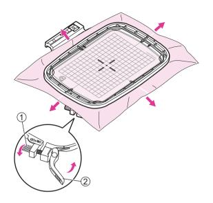
Coloque el bastidor interior en la tela y presione firmemente hasta que queden perfectamente ajustados al bastidor exterior. Si el bastidor interior no encaja adecuadamente, afloje el tornillo de fijación del bastidor exterior y ajuste hasta que encaje.
