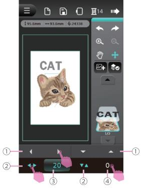
Haga clic en el icono Dirección para mostrar la lista multifunción. El valor predeterminado es 0. Los iconos de izquierda y derecha, arriba y abajo pueden ajustar la posición del eje X y del eje Y.
