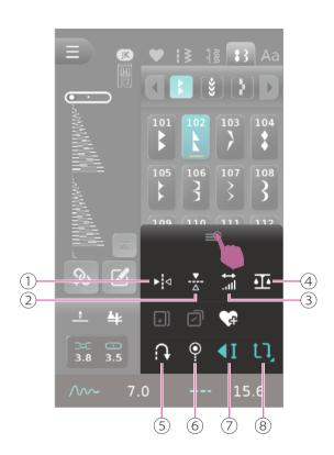
Después de seleccionar el patrón de puntada, abra la caja de herramientas para continuar con la configuración de la función del patrón de puntada.
