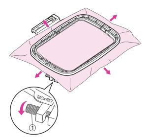
Coloque el bastidor en la tela y presione firmemente hasta que estén perfectamente encajados en el bastidor exterior. Si el bastidor interior no puede encajar adecuadamente, afloje el tornillo de fijación del bastidor exterior y ajuste hasta que encaje.
