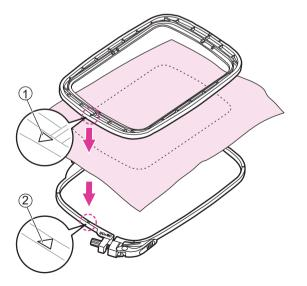
Coloque el bastidor exterior en un espacio plano resistente.
