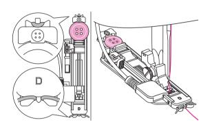
Instale el pie electronico y tome la cuerda y enchufe en la parte superior. coloque los extremos del hilo de hendidura en la parte delantera del pie e insértelos en las ranuras, luego átelos allí temporalmente. Baje la aguje y comience a coser.
