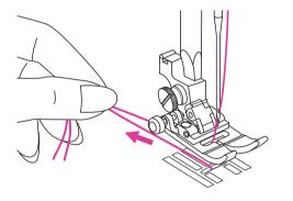
Tire de ambos hilos hacia la parte posterior debajo del prensatelas.
