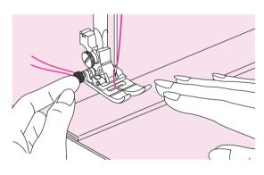
Cuando llegue a un punto de aumento de grosor, baje la aguja y suba el elevador del prensatelas. Presione la punta del prensatelas hasta la línea horizontal y presione el botón negro, luego baje el prensatelas y continúe cosiendo.
