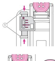
Considere la forma y la altura de cada botón, el ajustador de ajuste fino del ojal proporciona un ajuste fino de la longitud del ojal.
