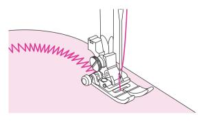
Al coser por la curva utilizando una puntada en zigzag, seleccione una longitud de puntada más corta para obtener una puntada más fina.
