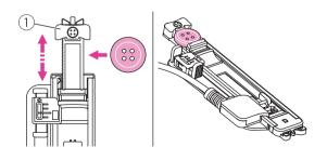
Tire de la placa del portabotones hacia atrás y coloque el botón en ella. Presione hacia atrás la placa del portabotones contra el botón para mantenerla apretada.
