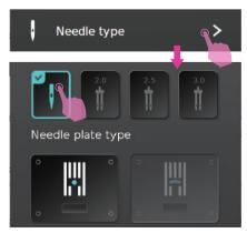
Después de cambiar a la placa de puntada recta, vaya a la configuración del tipo de aguja y elija una sola aguja, la máquina detectará automáticamente qué placa de aguja está usando.
