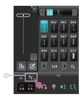
Si desea cambiar la dirección de costura, también puede ajustar la función del prensatelas en el modo de costura. Cuando deje de coser, la aguja permanecerá en la tela, y el prensatelas se levantará automáticamente, con lo que podrá girar la tela fácilmente. Esta función es muy útil. (Ajuste de la altura del prensatelas, por favor refiérase al capítulo "ajuste" para más información).
