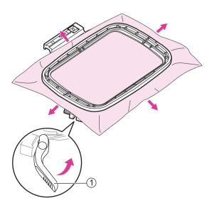
Coloque el bastidor interior en la tela y presione firmemente hasta que estén perfectamente encajados con el bastidor exterior, estire la tela desde los cuatro lados marcados con flechas para que la tela quede tensa el bastidor, luego presione el bastidor interior hacia abajo para que se hunda un poco en el bastidor exterior y cierre el dispositivo de liberación rápida.
