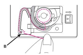
Para cortar el exceso de hilo, tire de él hacia el cortador en el punto (B).
