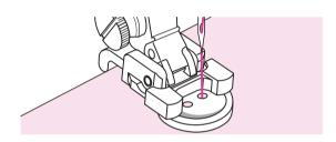
Coloque la tela debajo del prensatelas y coloque el botón en la posición deseada, luego baje el prensatelas.
