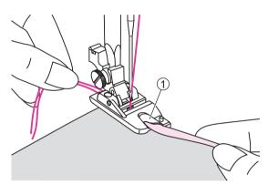
Introduzca la aguja en el pliegue girando el volante manual hacia usted, y baje el prénsatelas. Cosa varias puntadas y levante el prénsatelas.
