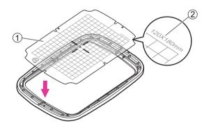
Coloque la lámina de bordado en el bastidor interior. Asegúrese de que la impresión del tamaño del bastidor queda en la parte superior derecha.
