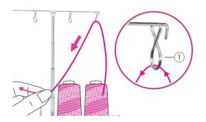
Tire del hilo y páselo a través de la guía del hilo en el soporte del hilo (de atrás hacia adelante). Finalmente, tire hacia abajo.
