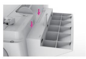
Insértelo de arriba hacia abajo en los soportes para tornillos. Una vez realizado, la instalación está completa.
