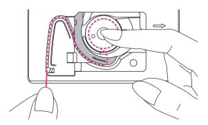
Con un dedo, sostenga suavemente la parte superior de la bobina, siga las marcas de las flechas y pase el hilo por la guía del hilo de la bobina.
