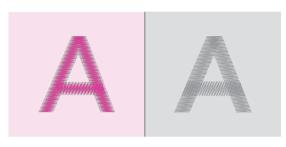
Cuando el hilo de la bobina es visible en la parte superior de la tela, significa que la tensión del hilo es demasiado fuerte para el bordado. Para reducir la tensión, presione el botón "—".
