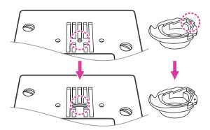
Reemplazar la placa de puntada recta a placa de aguja normal.
