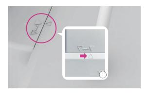
Empuje hacia la derecha y se fijará el soporte del portabobinas.
