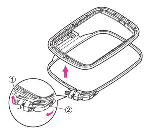
Afloje el tornillo de fijación o abra el dispositivo de liberación rápida (si se utiliza el mismo tipo de tela para bordar).
