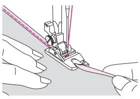
Baje el prénsatelas y empiece a coser despacio guiando el borde de la tela delante del prénsatelas para dobladillos de forma regular dentro del rollo del prénsatelas.
