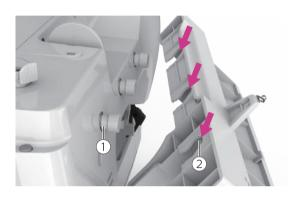
Alinee las tres ranuras de la base del carrete para la tapa trasera donde se fijan los soportes para tornillos.
