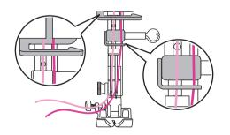
Como se muestra en la imagen, jale manualmente del hilo del portacarretes horizontal a través del orificio izquierdo de la aguja y del hilo del segundo portacarretes a través del orificio derecho de la aguja.
