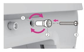
Saque los tornillos y soportes de tornillos de la bolsa de accesorios. Los tornillos deben ser insertados a través de los soportes de los tornillos. Luego inserte los 3 soportes de tornillos (con tornillos) en los orificios y apriételos en el sentido de las agujas del reloj.
