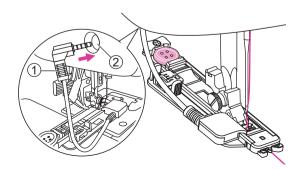
Coloque el pie electrónico para ojales y enchufe el cable en el enchufe detrás de la cubierta frontal.
